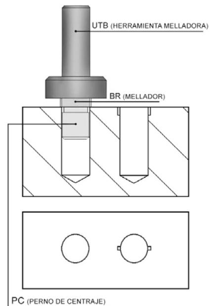
El modelo sin muelle **COD. RLA-SM** es insertado en el taladro después de haber realizado, con la herramienta apropiada, un alojamiento en el cual irá insertada la parte final de la lámina. La ventaja de esta aplicación está en el perfecto posicionamiento de la lámina, tanto en rotación como en profundidad, así como en el menor coste del componente debido a la ausencia del doble muelle.
